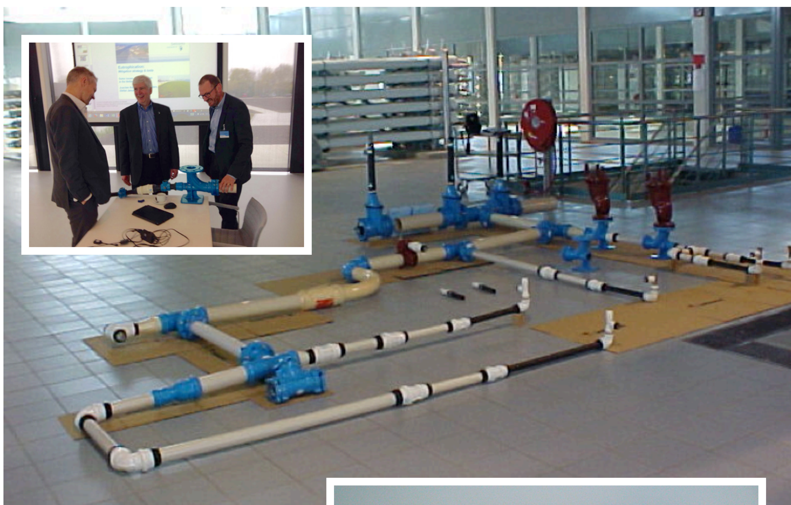
De materialen en appendages zoals gebruikt in een zelfreinigend leidingnet. Dit schaalmodel zal in werkelijkheid enkele honderden meters lang kunnen zijn.
