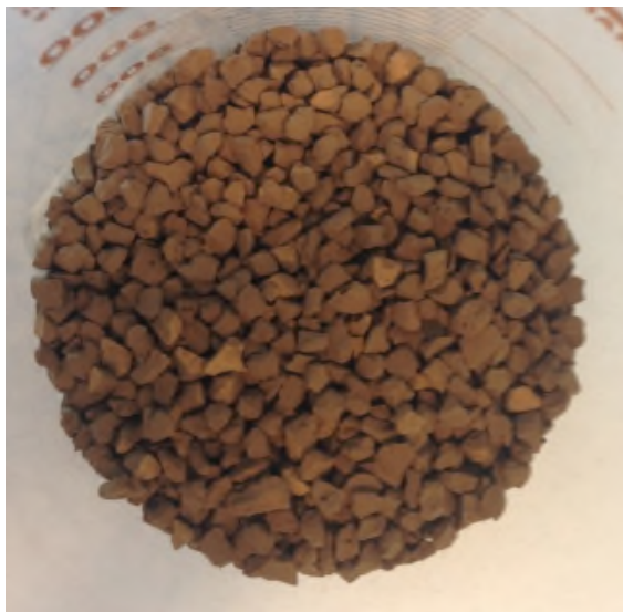
FIGUUR 6-1 FOTO GRANULAIR WATERIJZER, FRACTIE 3,2 - 4 MM.
