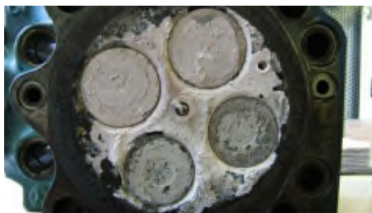
FIGUUR 3-2 SILICIUM AFZETTINGEN IN EEN WKK (JONKER 2016).
