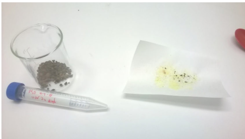
FIGUUR 8-1 FOTO MAXIMAAL BELADEN ONTBRANDE WATERIJZERKORRELS.
